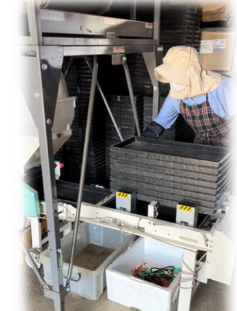
播種機で種まきをします。 まず苗箱を供給機に 箱を重ねます。
